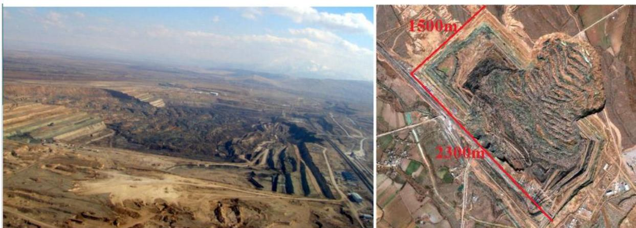
Рисунок А17 – Оползень на угольном разрезе
