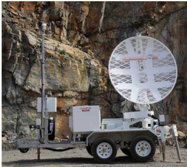
Рисунок В3 – Управление рисками путем прогнозирования точного времени момента обрушения, чтобы вовремя эвакуировать персонал (параметр ВВ)
