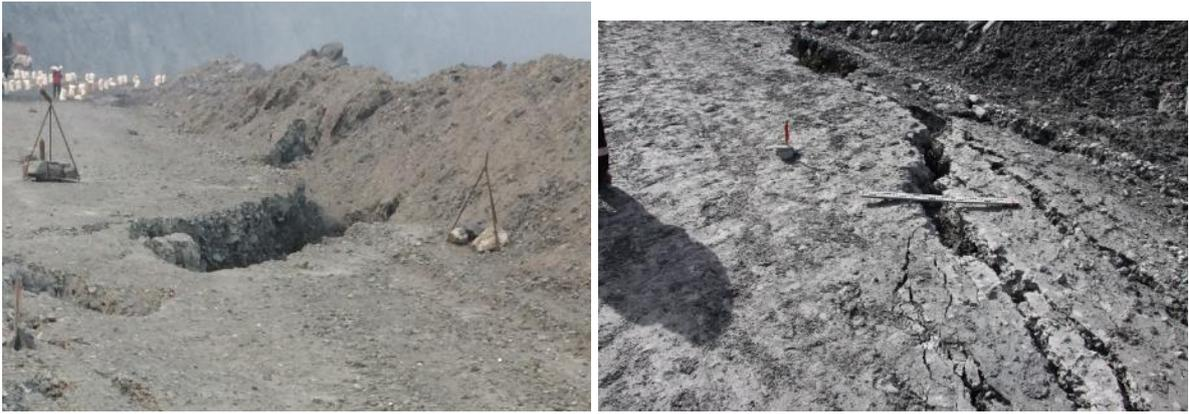
Рисунок 3.13 – Определение раскрытия трещин: экстензометр и рейка
