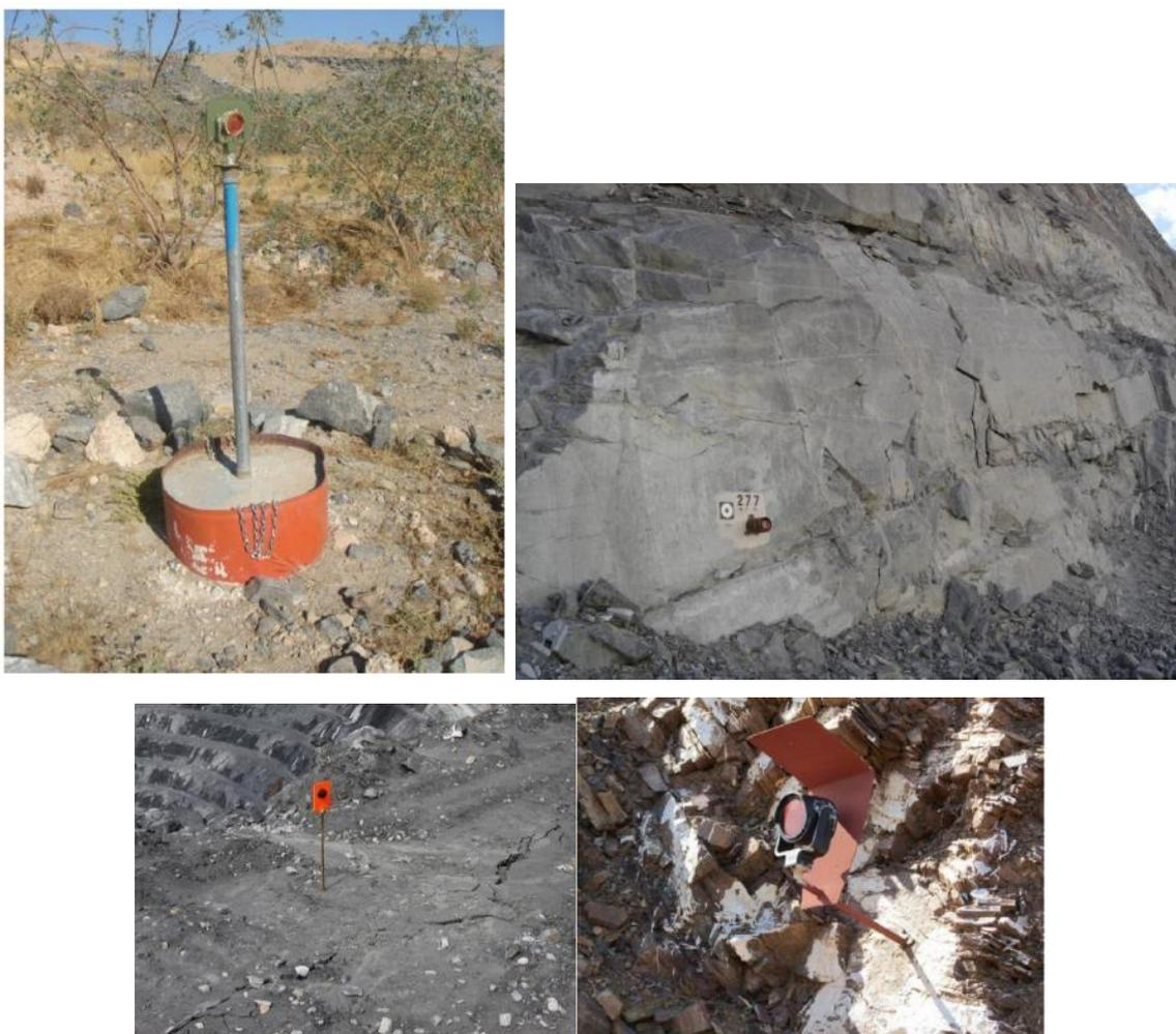
Рисунок 3.8 - Пример установки стационарных отражательных призм
