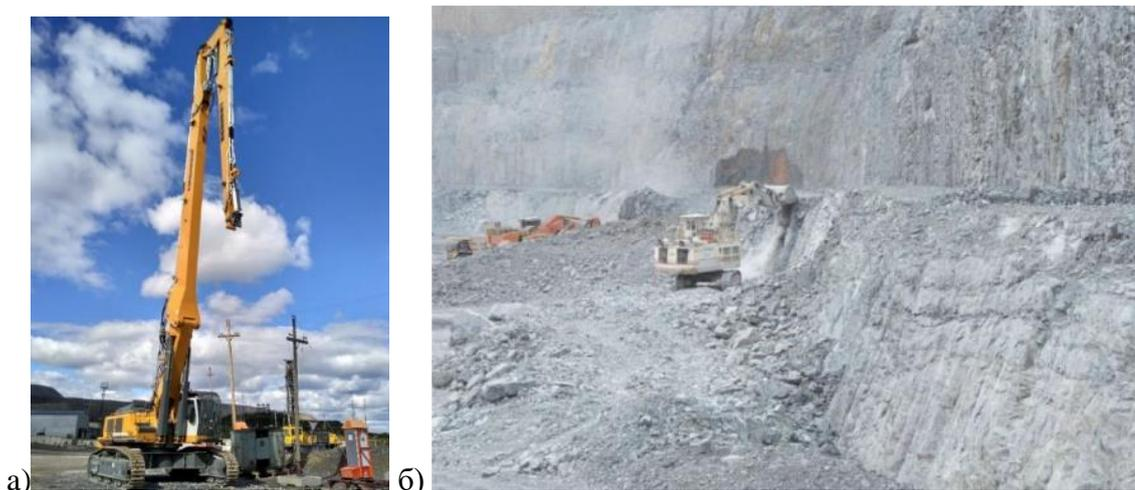
Рисунок 4.8 – Заколооборочная машина (а) и оборка уступов экскаватором (б)
