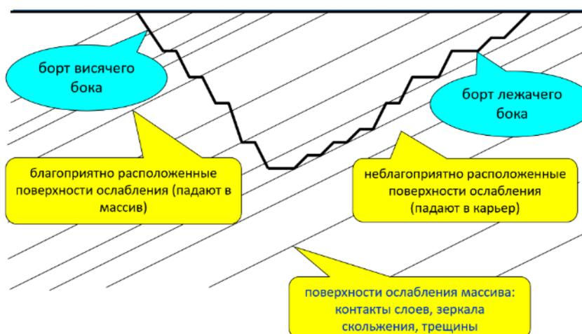
Рисунок А5 – Структурная схема неблагоприятных структур для месторождений слоистого типа
