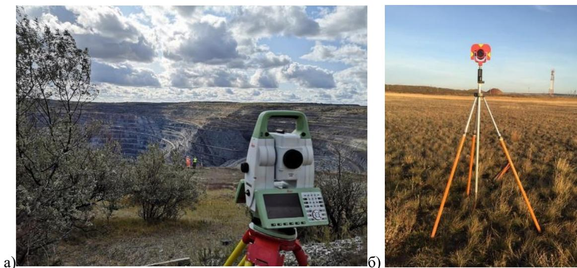
*а) электронный тахеометр, б) отражатель на жестком отвесе*
