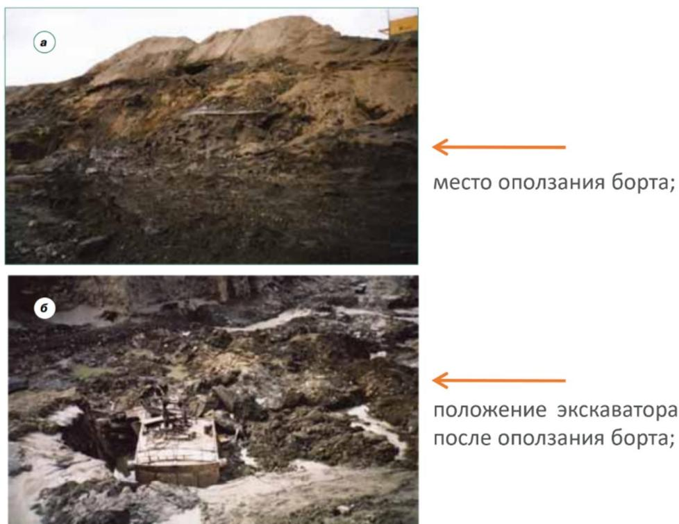
Рисунок А25 – Деформации борта карьера в многомерзлых породах
