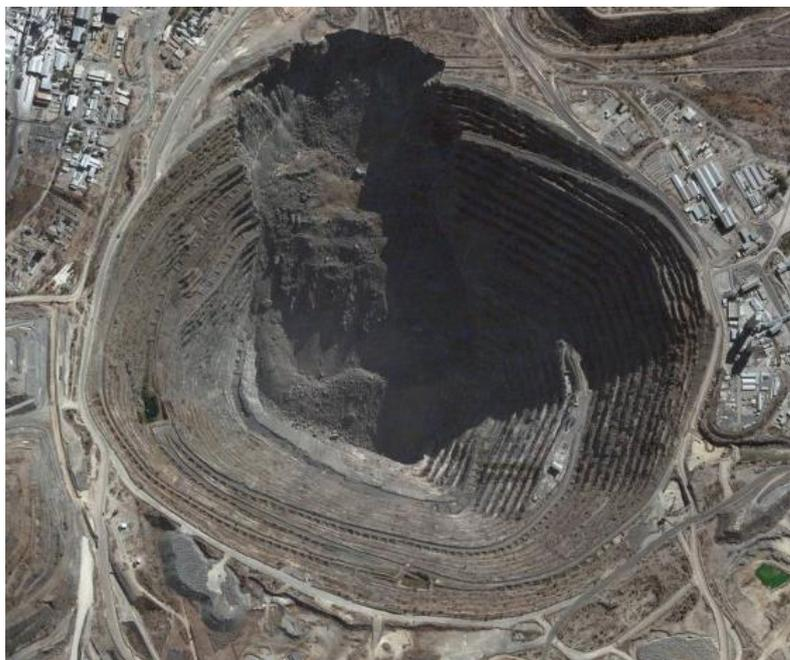
Рисунок А20 – Деформация, связанная с подземной подработкой на карьере медного месторождения
