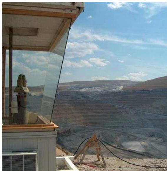
Рисунок 3.9 – Станция призмного мониторинга
