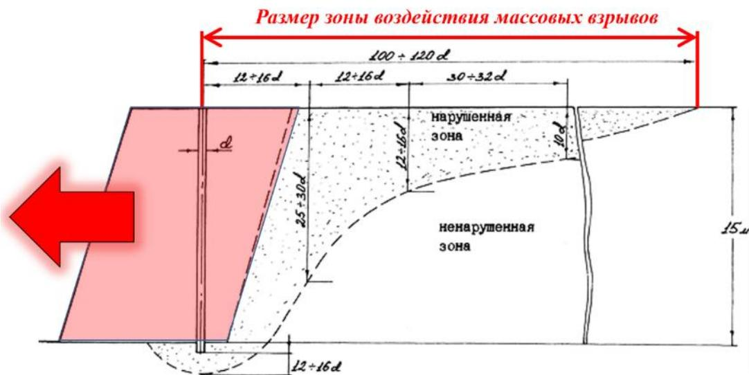
Рисунок 4.1 – Типовые представления о масштабах повреждения массива массовым взрывом за контуром отбойки
