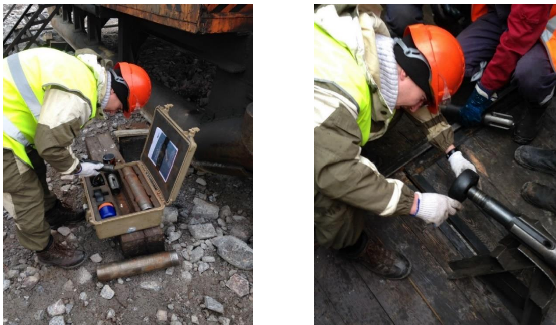
Рисунок 0.2 – Ориентирование прибором Reflex
