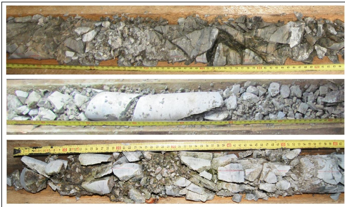
Рисунок 3.6 – Пример трещин по ослаблению [2]
