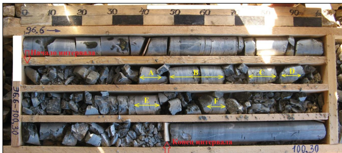
Рисунок 3.10 – Пример определения цельного выхода керна [2]
