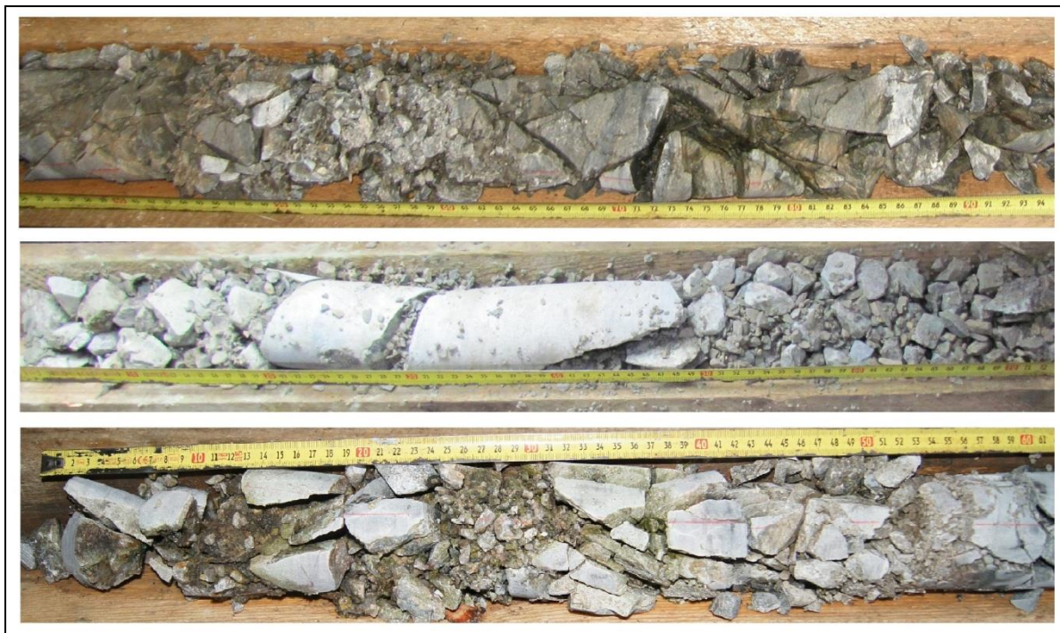
Рисунок 3.6 – Пример трещин по ослаблению [2]
