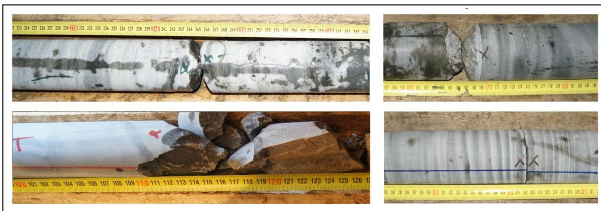
Рисунок 3.3 – Пример трещин механического происхождения [2]
