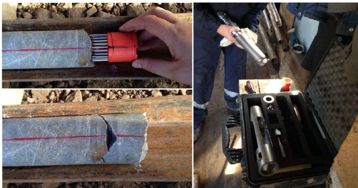
Рисунок 0.1 – Пример ориентирования керна механическим способом
